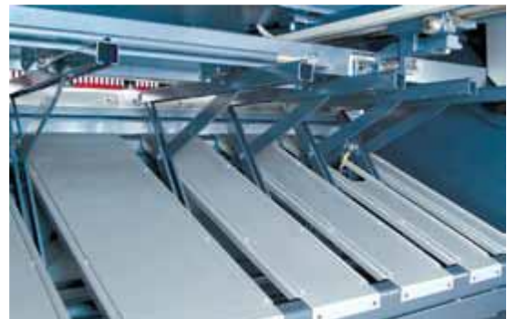
Pneumatski držači lima
