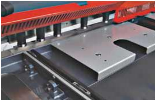
Preklopna zaštita za prste dužine 1m
