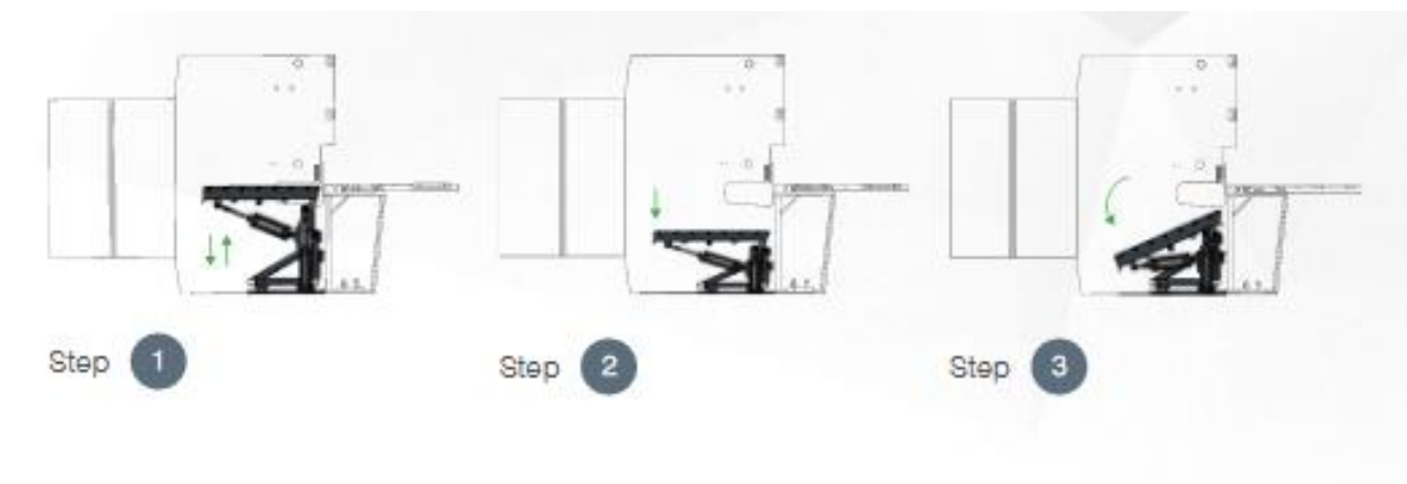
Pneumatski držač lima Durma IV.
